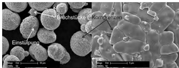
Bild 2 REM Aufnahme von Mikrovaristoren [2]
