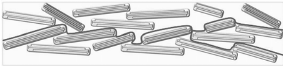
Bild 5 Iriotec(R) Partikeln in einer Matrix mit angedeutetem Leitpfad (schematisch) [3]
